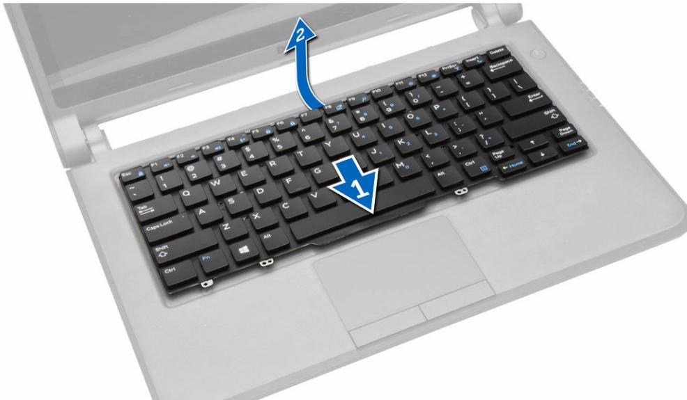
5. Déle la vuelta al teclado, desconecte el cable del teclado de su conector y saque el teclado del equipo.
